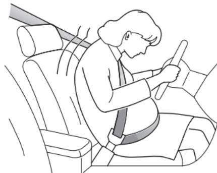
La sezione diagonale della cintura di sicurezza deve passare sul torace normalmente, la sezione addominale della cintura deve passare sotto la pancia, bassa e aderente alle ossa dell'anca. La cintura non deve essere **MAI** posizionata direttamente sopra o al di sopra della pancia.
