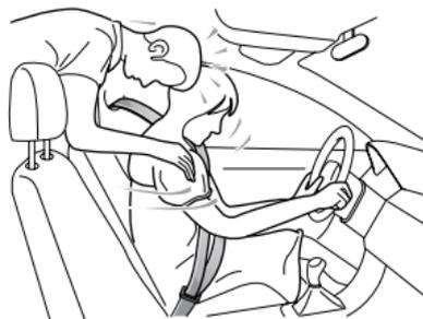
Quando il veicolo è in movimento, la velocità di spostamento degli occupanti è identica a quella del veicolo. In caso di "collisione frontale" o di frenata d'emergenza, il veicolo può arrestarsi, ma gli occupanti continueranno a essere proiettati in avanti finché non entreranno in contatto con un oggetto fermo. Questo oggetto può essere il volante, il cruscotto, il parabrezza o altro ancora.
