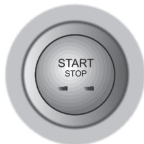
L'interruttore START/STOP senza chiave si trova nella fascia a destra del piantone dello sterzo, è un interruttore a pulsante. Per poter azionare l'interruttore occorre che la Smart Key sia all'interno del veicolo.
