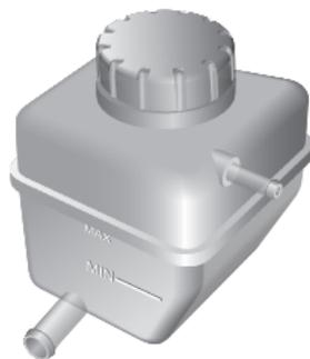
Il sistema di raffreddamento dovrebbe essere controllato settimanalmente a freddo e con l'automobile posizionata su un terreno pianeggiante. Aprire il cofano e controllare il livello del refrigerante. Se il livello del refrigerante è al di sotto della tacca "MIN", aprire il tappo del serbatoio di espansione del refrigerante e rabboccare. Il livello del refrigerante non dovrebbe superare la tacca "MAX".
