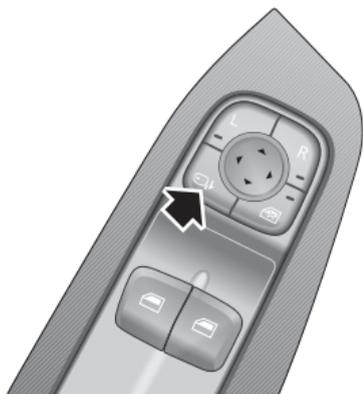
**Nota:** Per i veicoli dotati di specchietti esterni ripiegabili, la funzione di ripiegamento dello specchietto esterno può essere realizzata anche toccando l'interruttore di piegamento dello specchietto che si trova nello schermo del display di intrattenimento.
