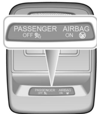
La spia di stato dell'airbag passeggero è sistemata nel gruppo luci abitacolo montate nel padiglione. La forma del gruppo luci varia a seconda della configurazione del veicolo.
