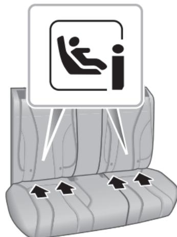
3 Per fissare la cinghia di fissaggio superiore (Top Tether) del sistema di ritenuta per bambini, far passare la cinghia di fissaggio sotto il poggiatesta e attaccarla al gancio di ancoraggio facendo attenzione a non attorcigliare la cinghia. Se non si utilizzano gli ancoraggi inferiori ISOFIX, utilizzando la cintura di sicurezza,
